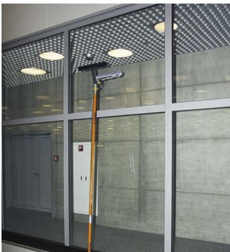
Die ideale Lösung für eine effiziente und einfache Innenreinigung: Sprühen und über Strato-Carbonrohre sauber absaugen.
